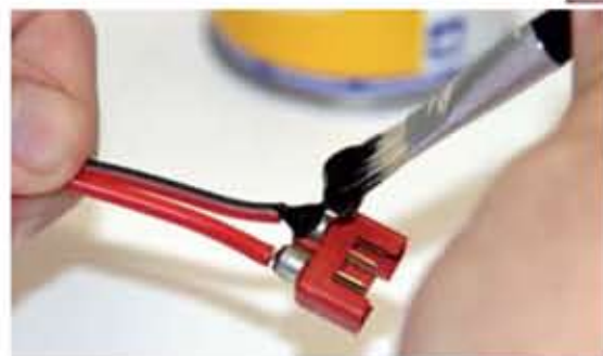
Diese unzugänglichen Lötkontakte lassen sich schnell und einfach mit Liquid Tape isolieren
