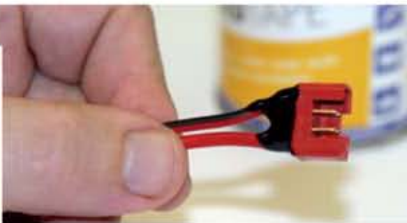
Diese unzugänglichen Lötkontakte lassen sich schnell und einfach mit Liquid Tape isolieren
