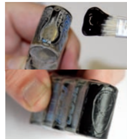
Ein aufgescheuerter Akku ist leicht mit dem Pinsel zu reparieren. Eine dünne Schicht reicht schon aus. Zudem reduziert sich die Masse beim Trocknen sehr deutlich und passt sich so ganz exakt dem Untergrund an
