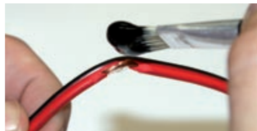
Natürlich können Kabelbrüche mit Plasti Dip überzogen werden
