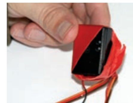
Ganz leicht kann der dauerflexible Schutzfilm rückstandslos wieder entfernt werden. Plasti Dip haftet auf fast allen Untergründen, lässt sich aber einfach wieder abziehen
