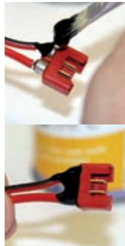
Vorher/Nachher: Diese unzugänglichen Lötkontakte lassen sich schnell und einfach mit Liquid Tape isolieren
